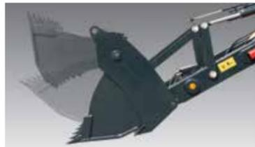
Evita la apertura accidental de la cuchara de almeja por el peso de la carga durante los procesos de carga y excavación.
