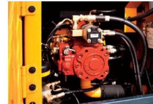
Para lograr una precisión óptima, Hyundai rediseñó el sistema hidráulico para ofrecer al operador un tacto de alta calidad y gobernabilidad mejorada. El control de flujo de la bomba mejorado reduce el flujo cuando los controles no se usan para minimizar el consumo de combustible.
